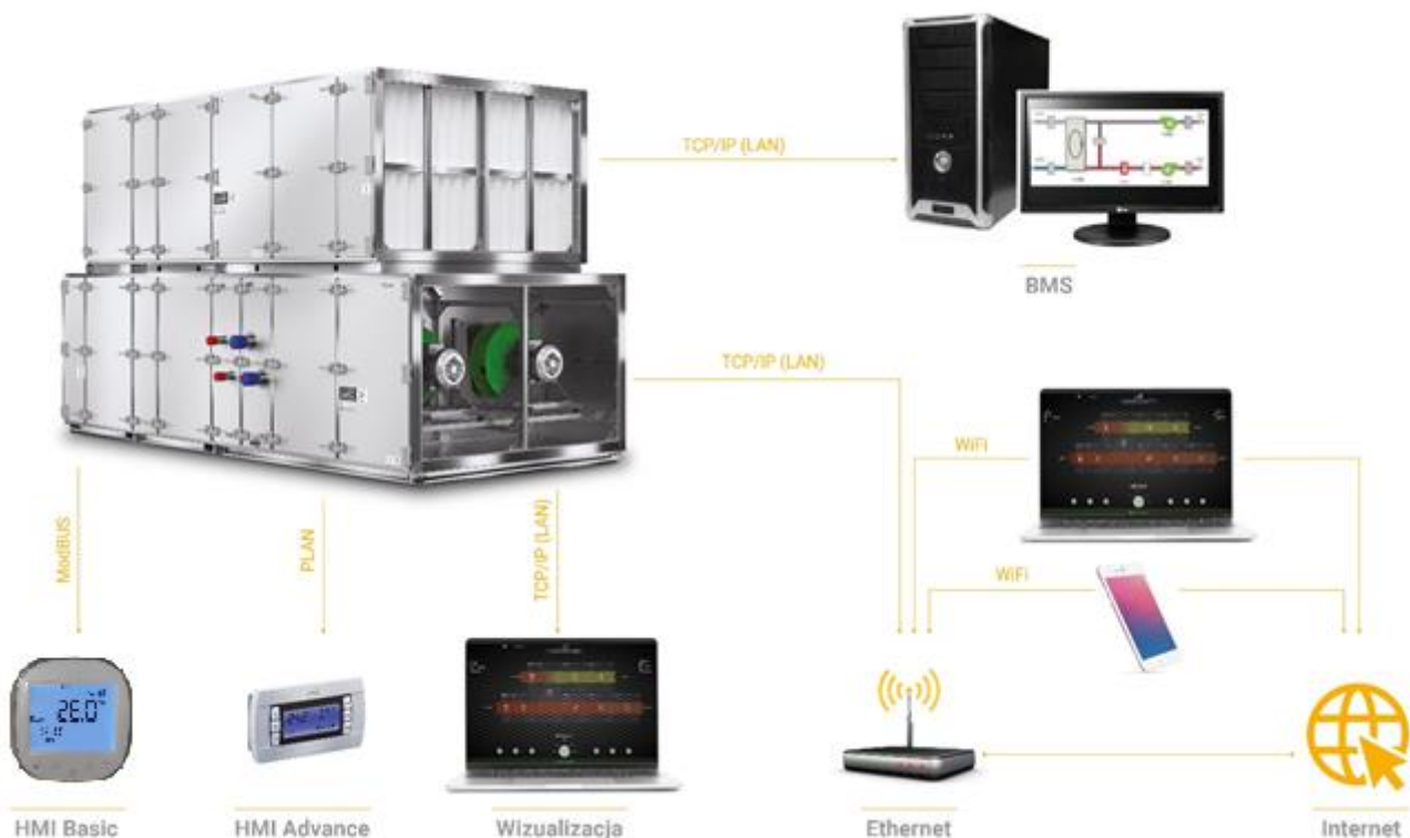
Rys. 13. Możliwości obsługowe sterownika centrali VENTUS.
